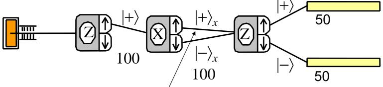
Misura addizionale per determinare la proiezione di spin lungo x
