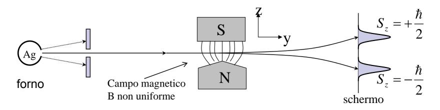
Un atomo di argento si comporta come un piccolo magnete. Il numero atomico dell'argento è 47. L' atomo di argento ha lo strato più esterno (n=5) con un solo elettrone. La deflessione degli atomi nell'attraversare il magnete è dovuta al momento di dipolo magnetico intrinseco dell'elettrone.
