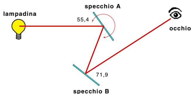
Dati una lampadina, uno specchio A di orientamento variabile e uno specchio B, si vuole colpire l'occhio di un osservatore con un raggio luminoso proveniente dalla lampadina.
