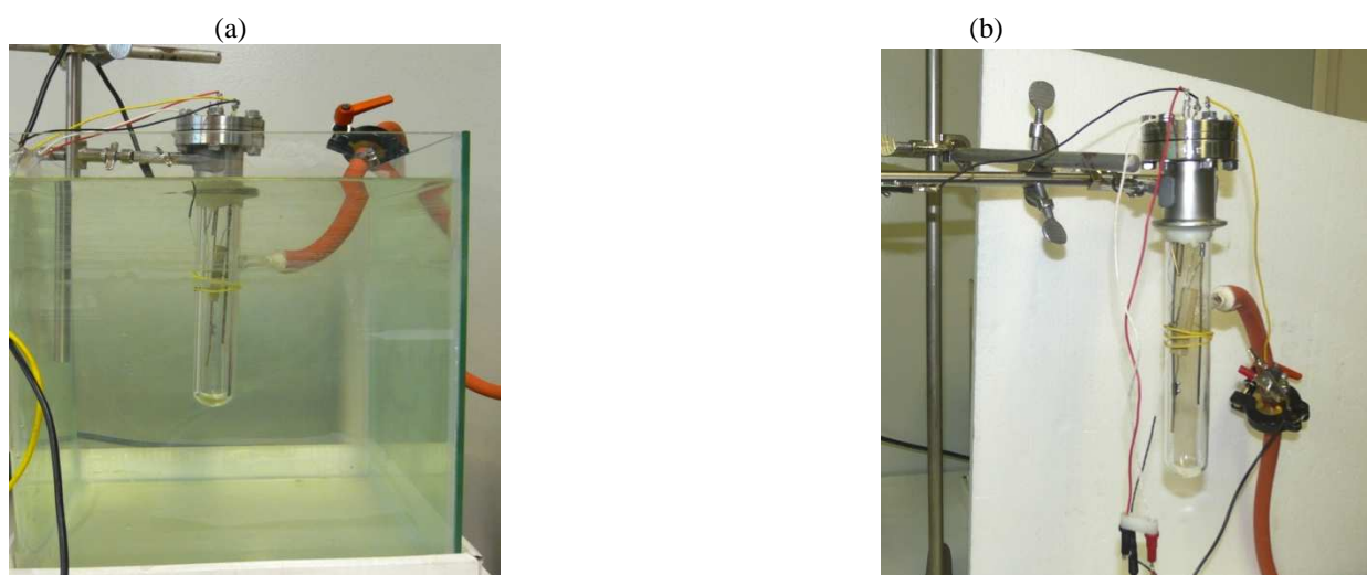
Figura 3. Dettaglio dell'apparato sperimentale: (a) tubo immerso in acqua, (b) tubo lasciato in aria.
