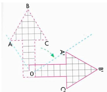
Fissato l'angolo e il centro di rotazione, per disegnare in  $F'$  il punto  $A'$ , corrispondente del punto  $A$  nella figura  $F$ , si punta il compasso in  $O$  e con apertura uguale al segmento  $OA$  si descrive in senso orario (o antiorario) un arco corrispondente all'ampiezza dell'angolo.
