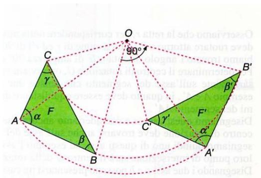
Una rotazione stabilisce tra i punti del piano una corrispondenza biunivoca che dà origine a una isometria. Il centro di rotazione può essere interno o esterno alla figura.
