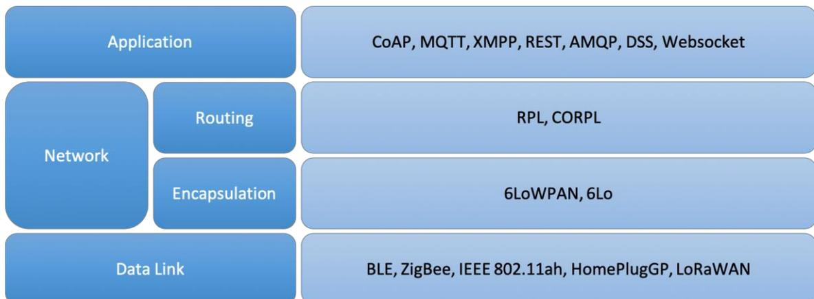
Figura 1 - Stack dei Protocolli IoT
