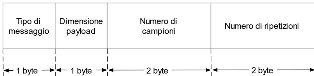
Figura 4.2 - Struttura del messaggio di configurazione
