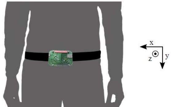
Figura 3.1 - Orientamento e disposizione del dispositivo indossato ad un soggetto
