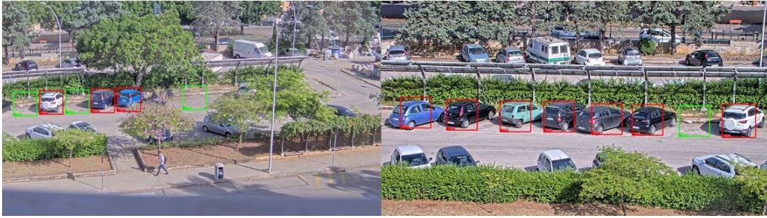
Figura 4.7: Esempio di output del modello combinato con due videocamere che inquadrano il parcheggio del plesso universitario. I bounding box e le predizioni sono stati aggiunti come overlay al flusso video fornito dalle videocamere.
