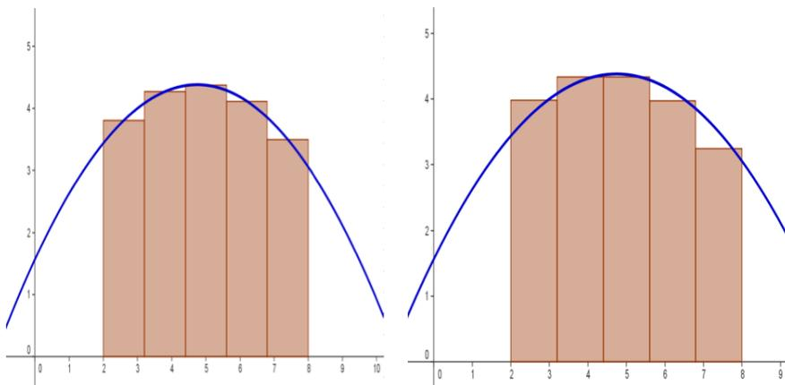
FIGURA 4. Rettangoli ottenuti scegliendo punti arbitrari  $x_i^*$  nei sub-intervalli  $[x_{i-1}, x_i]$
